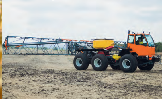
ТУМАН-2М В МОДИФИКАЦИИ ВЫСЕВАЮЩИЙ МОДУЛЬ
