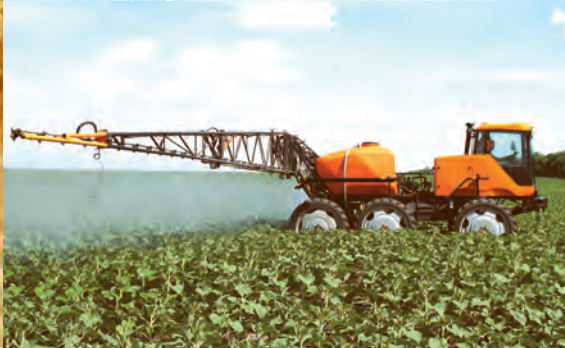
ТУМАН-3 В МОДИФИКАЦИИ ШТАНГОВЫЙ ОПРЫСКИВАТЕЛЬ
